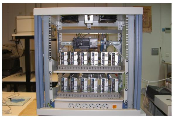
300V – 11A. Suministro de potencia al nodo submarino a través del cable. Un PLC gestiona el número de fuentes en serie necesarias para suministrar la potencia suficiente. El PLC es controlado y monitorizado via Eth mediante protocolo SNMP
